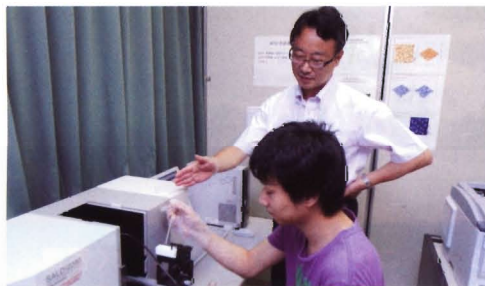
超音波を当てた後の超伝導体をセルに入れてレーザー回折式粒度分布測定装置にかけ、コロイド状に分散しているかどうかを検証。結果はパソコン画面上の分布曲線で確認できる
