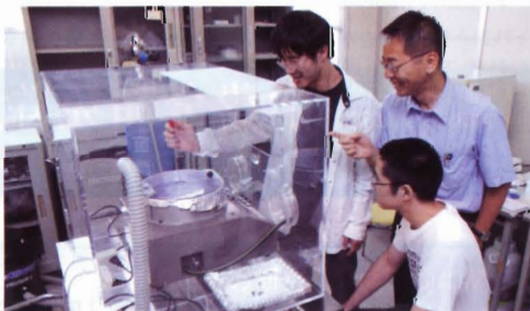
実験用太陽電池を作製するのは約2日。条件を少しずつ変えながら、変換効率アップを自力で模索する。中尾さんの場合はこれまで0.2%のアップという成果をあげた
